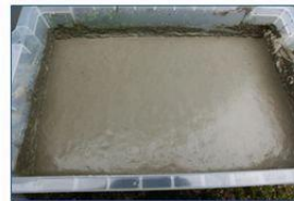
金コテ仕上げ試験体
